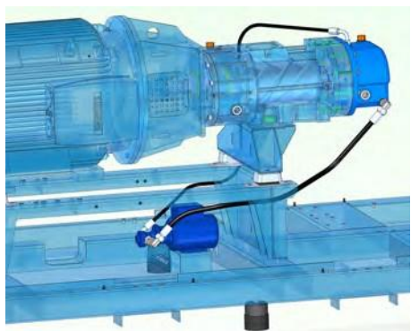
Рис. 16: Насос для смазки редуктора ступени компрессора
