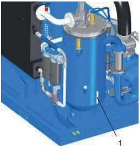
Рис. 36: Проверка уровня компрессорного масла через смотровое стекло
