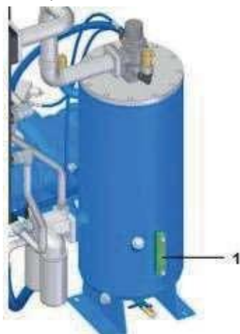
Рис. 31: Проверка уровня компрессорного масла через смотровое стекло
